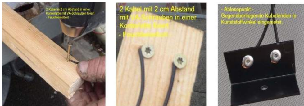
Abbildung 2: Feuchtemesspunkte, vor dem Einblasen von Dämmung zum dauerhaften Verbleib einzubauend
