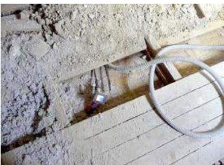
(7) Mit einem Endoskop kann die Füllung der Holzbalkendecke geprüft werden.
